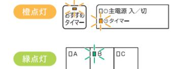
スイッチを押すごとにセット・解除が行えます。タイマーは約3秒後に確定します。現在時刻がキープ運転の時間の時は、選択している系統ランプが(緑)から(黄)に変更になります。 [21ページ](#)
