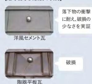
試験条件: JIS A5423に準じる(メーカー試験結果) 施工状態で2.530gの鉄球を所定の高さから落下させ目視により破損状況を確認。
